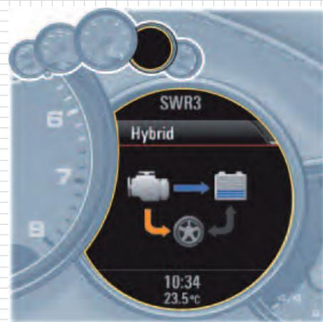
Le graphique suivant représente une élévation du point de charge à env. 2 400 1/min. Le rendement du moteur thermique peut alors augmenter d'environ 10% (plage 1 28% → plage 2 38%).
