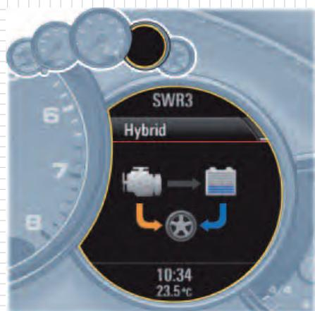
Tandis qu'en Cruising, le couple de freinage de l'E-Machine est abaissé de manière ciblée, pour la récupération le module de gestion hybride augmente la puissance de l'alternateur avec précision. Pour cela, le niveau de tension dans le bobinage du stator de l'E-Machine est augmenté, ce qui produit un flux de courant plus élevé quand le rotor tourne. La hausse de la puissance de l'alternateur agit comme un couple de freinage croissant sur l'arbre d'entraînement et ralentit le véhicule.
